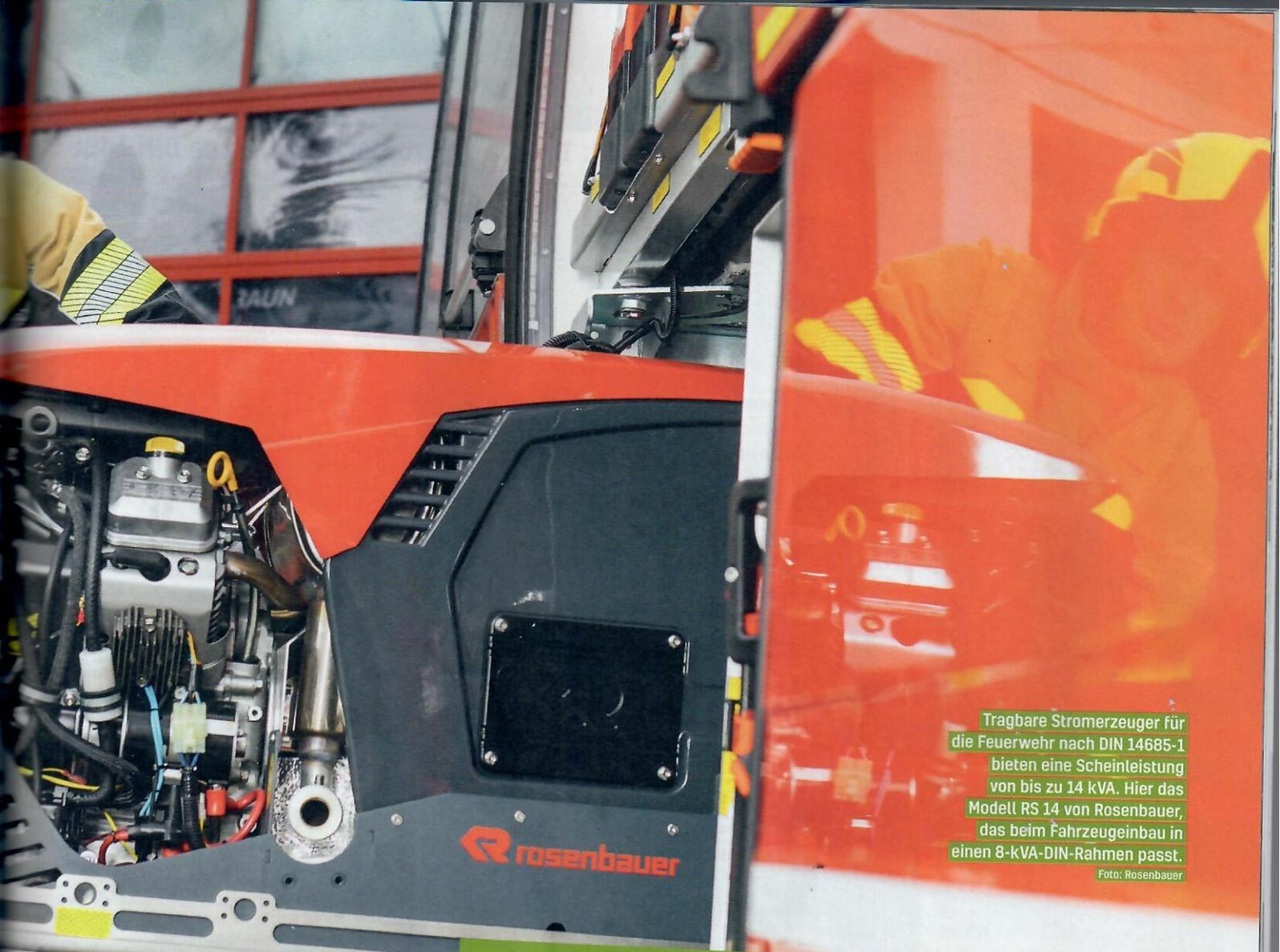
Tragbare Stromerzeuger für die Feuerwehr nach DIN 14685-1 bieten eine Scheinleistung von bis zu 14 kVA. Hier das Modell RS 14 von Rosenbauer, das beim Fahrzeugeinbau in einen 8-kVA-DIN-Rahmen passt.
